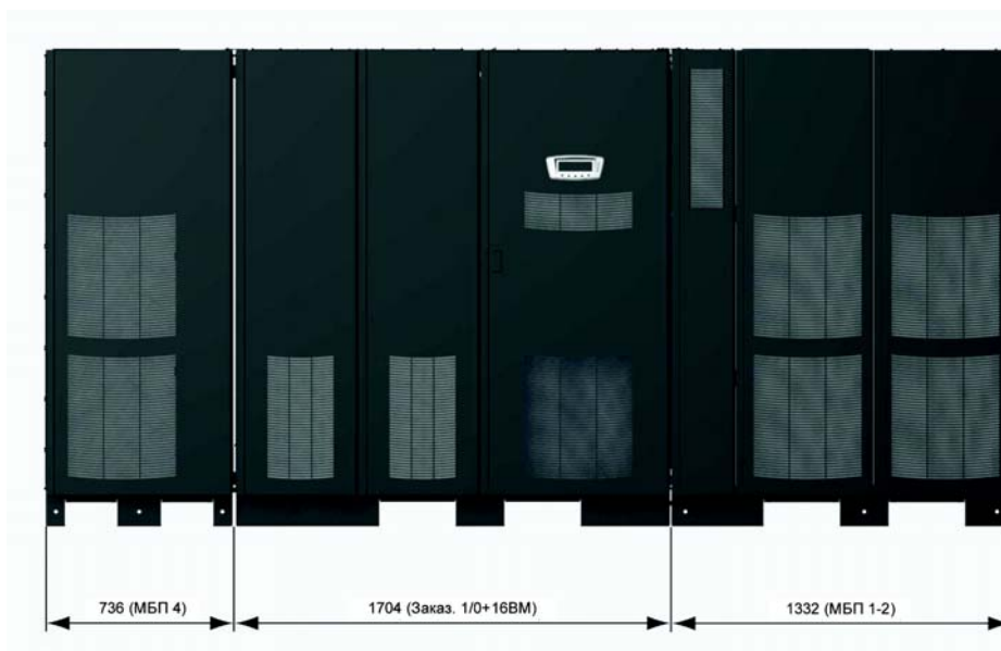
Рис. 3-2. Габариты шкафа ИБП (вид спереди) - 825/550 кВА
