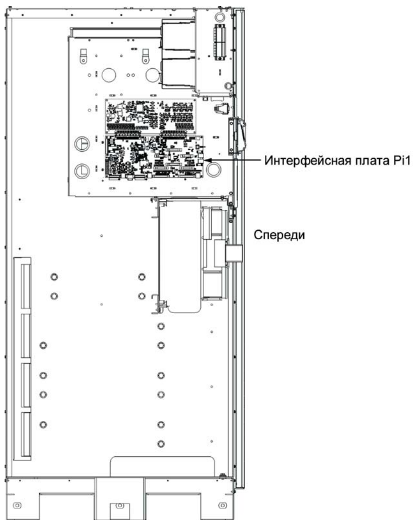
Рис. 4-12. Расположение интерфейсной платы P11
