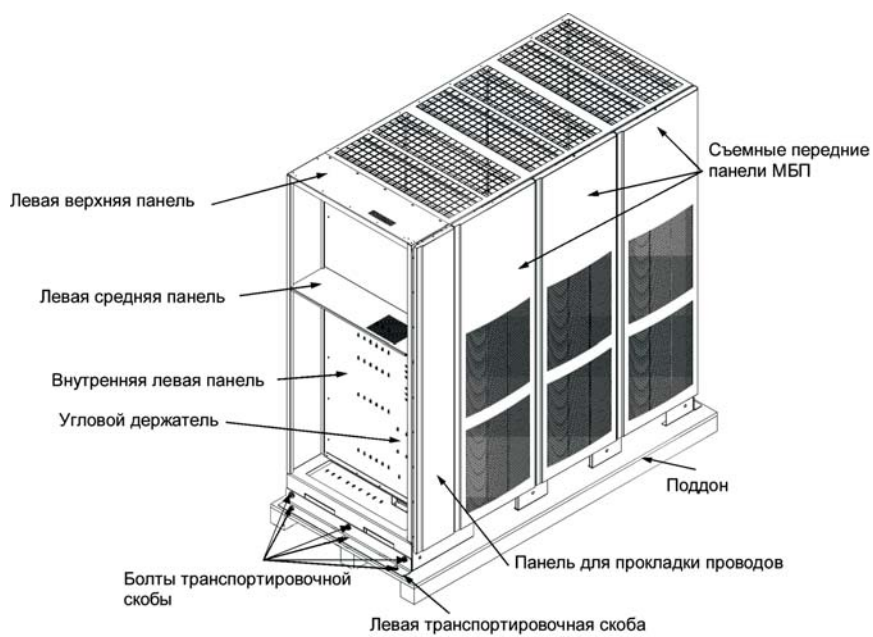
Рис. 4-3. Отсоединение левой транспортировочной скобы секции UPM
