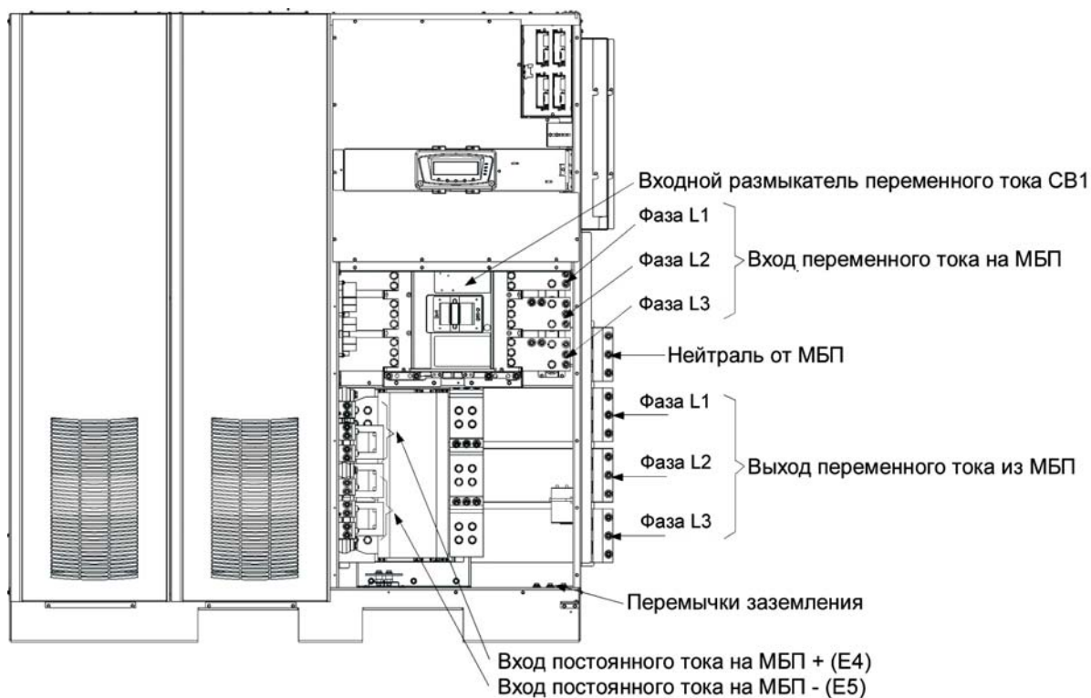
Рис. 4-7. Расположение межстоечных клемм питания секции ISBM ИБП
