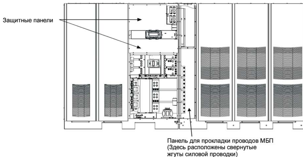
Рис. 4-5. Соединенные секции ISBM и UPM
