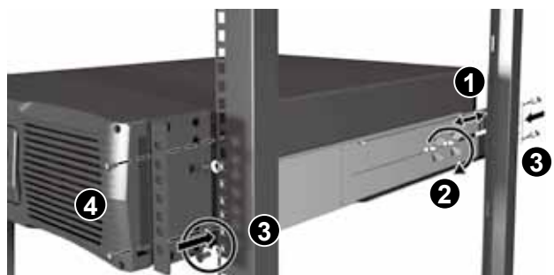
Рис. 3б. Монтаж ИБП в стойку
